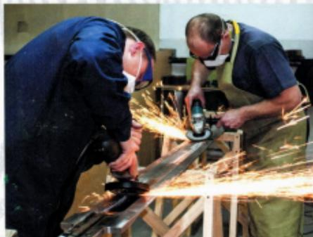
Après la mise en forme de la lame et le fraisage des gorges, vient le travail de finition. Tout se fera manuellement, d'abord à la disqueuse, avec des grains dégressifs, puis le tiré de long s'effectuera à l'aide de cales à poncer. Le polissage final se fera à l'aide de machines portatives.
